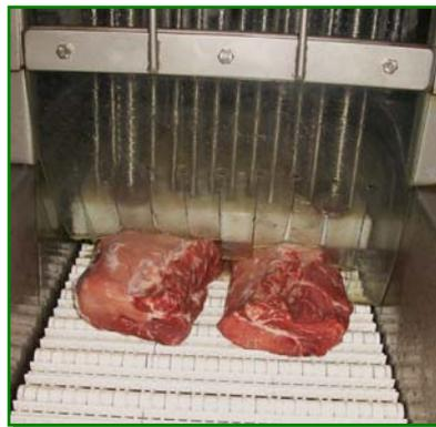
**Figura 13.** Incorporación de la salmuera con la inyectora multiagujas.
